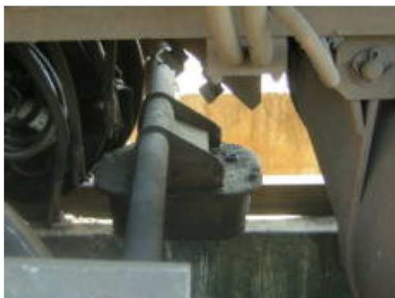
Baliza ASFA. Baliza instalada en la vía y receptor situado en el tren
