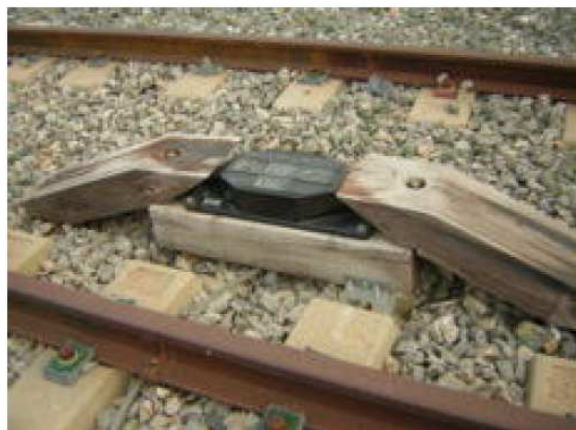
Baliza ASFA. Baliza instalada en la vía y receptor situado en el tren
