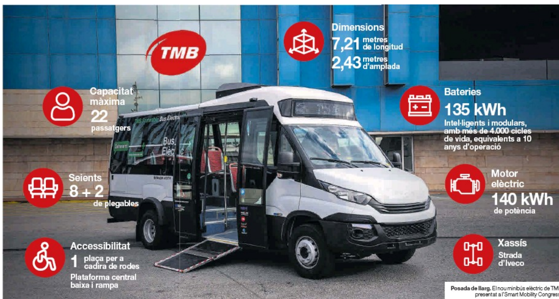
Figura 3. Aspecte del prototipus de minibus elèctric, desenvolupat dins del projecte Ris3CAT
