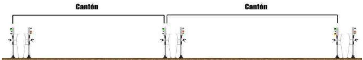
Bloqueo Automático en vía Única (BAU)
