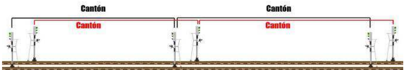
Bloqueo Automático en vía Doble (BAD)
